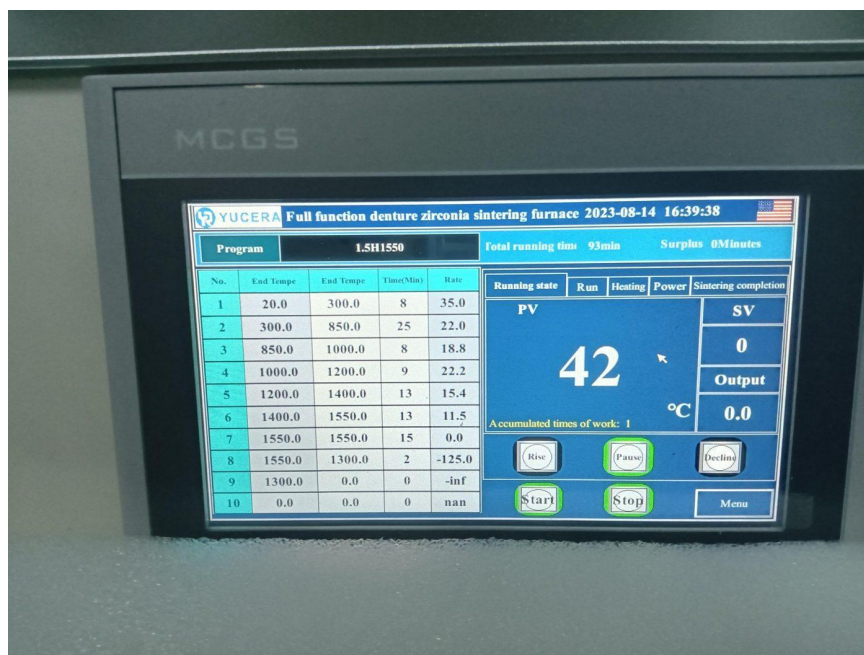
Pantalla principal — programa, curva de temperatura, estado de ejecución, PV/SV y botones de control (Rise, Pause, Decline, Start, Stop, Menu)
