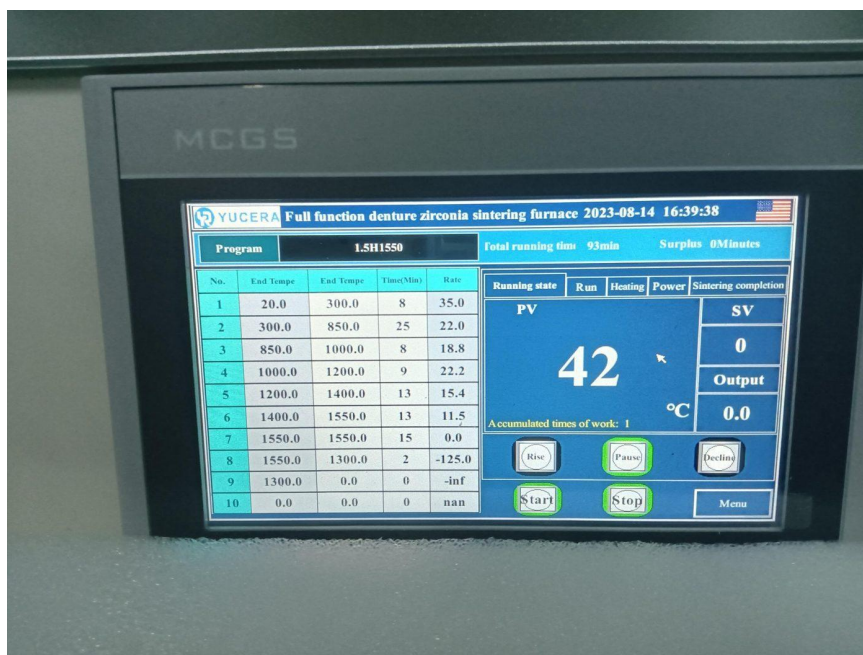
Tela principal — programa, curva de temperatura, estado de execução, PV/SV e botões de controle (Rise, Pause, Decline, Start, Stop, Menu)
