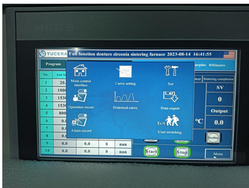
Menú principal — Interfaz de control principal / Configuración de curva / Ajustes / Registro de operación / Curva histórica / Exportación de datos / Registro de alarmas / Salir / Cambio de usuario
