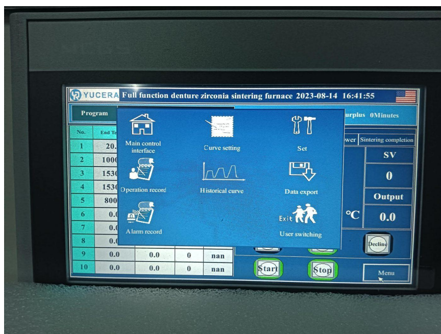
Menu principal — Interface de controle principal / Configuração de curva / Configurações / Registro de operação / Curva histórica / Exportação de dados / Registro de alarmes / Sair / Troca de usuário
